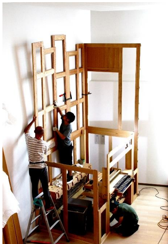
← 上に伸びる筐体、手前下の黒い箱は送風機
