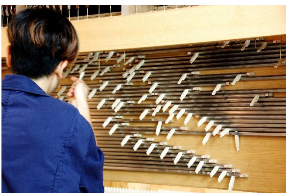
手鍵盤のトラッカーアクションの調整
